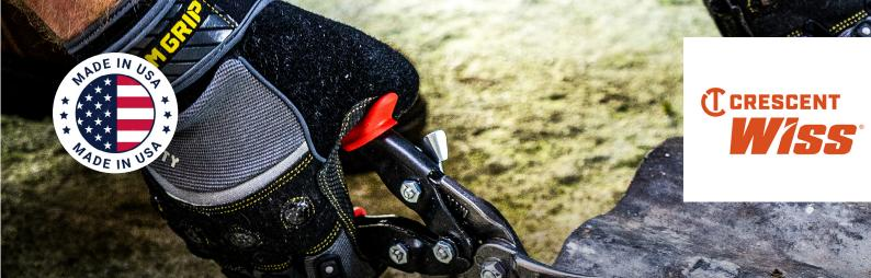
Le ganasce seghettate e antiscivolo di Wiss® Metalmaster sono realizzate in acciaio al molibdeno resistente all'usura ed extra-robuste per fornire le prestazioni aggiuntive richieste dall'azione di leva composta.
