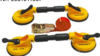
Due doppie ventose per il trasporto, il montaggio e lo smontaggio di parabrezza e altri vetri. Viene fornito con una cinghia che tiene il parabrezza in posizione mentre la colla si asciuga.
